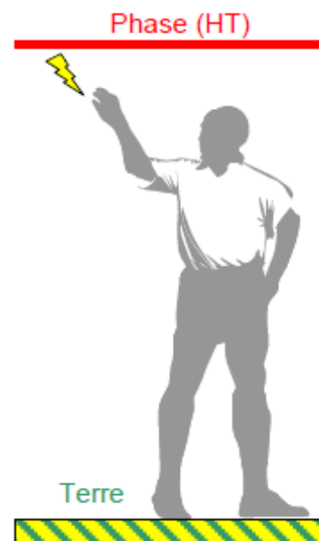
Figure 35 : Schéma du risque d'amorçage électrique
