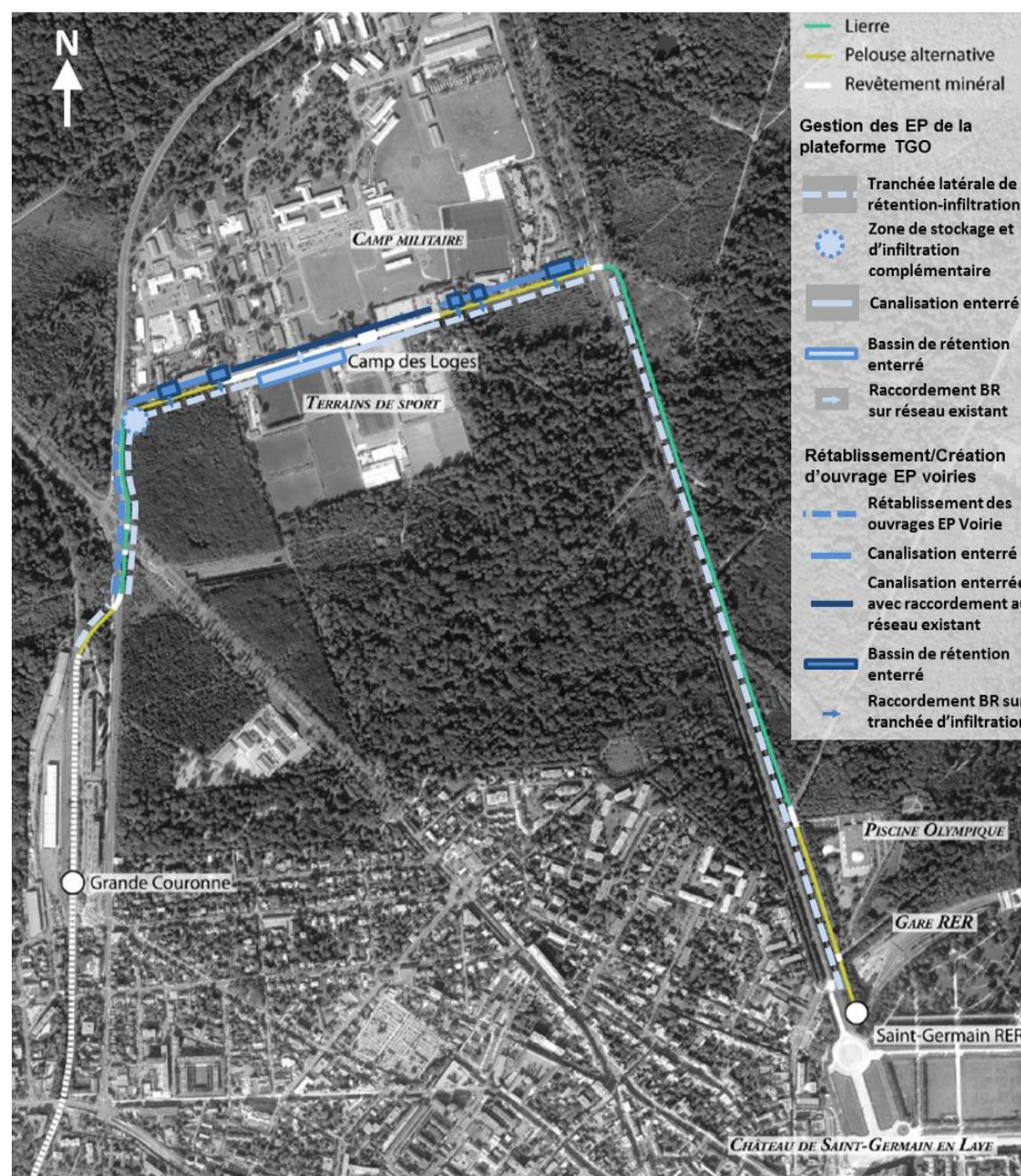
Figure 43 : Synoptique hydraulique à Saint-Germain-en-Laye
